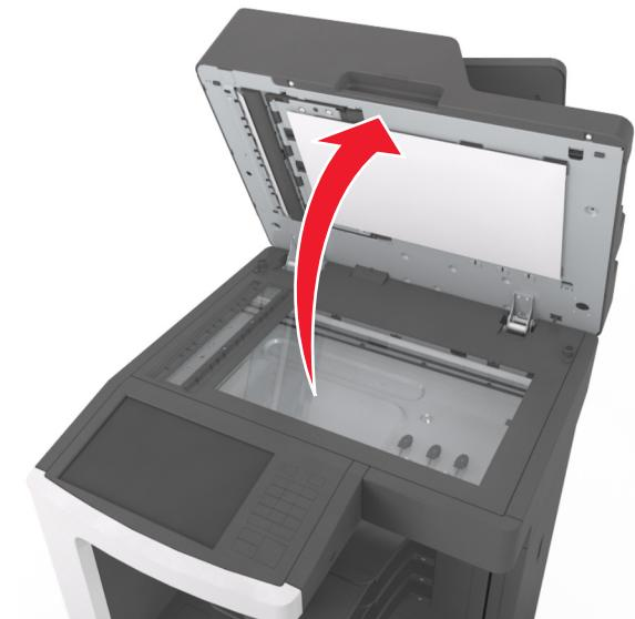
**6** 如果纸张卡在底部 ADF 盖门或 ADF 输出接纸架中，请打开底部 ADF 盖门，然后用力抓住被卡纸张的两边。
