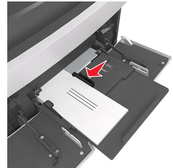
**警告—可能的损坏：**永远不要使用带有邮票、卡扣、摁扣、窗口、涂层或自动粘胶的信封。这些信封可能会严重损坏打印机。
