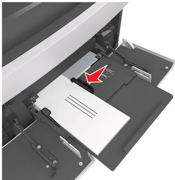
**警告—潛在損害：**切勿使用有郵票、拴扣、勾環、窗格、覆膜襯裡或自黏式的信封。這類信封可能會嚴重損壞印表機。
