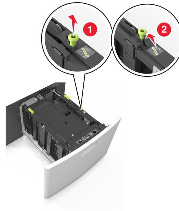
b 若 A5 長度導引夾仍連接到長度導引夾，請從其所在位置將它取出。若未連接 A5 長度導引夾，請繼續執行步驟 d。
