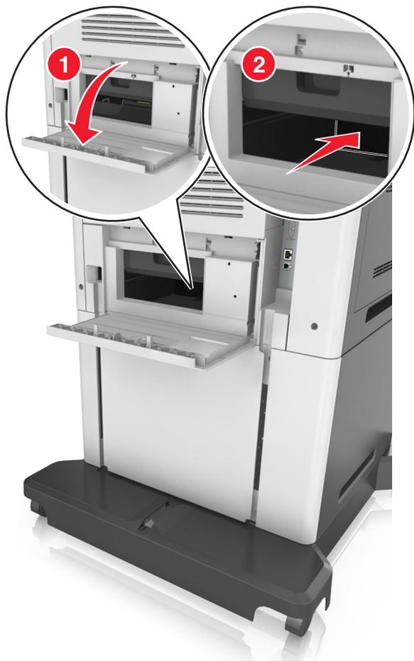
5 按下雙面列印裝置的后蓋，抓緊夾紙，然後輕輕將紙張拉出。
