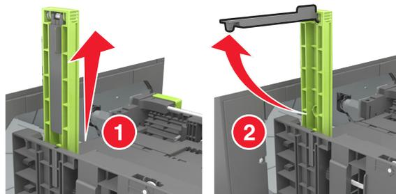
d 將 A5 長度導引夾插入它的指定插槽。
