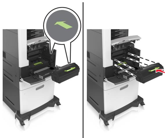
**Avvertenza — Danno potenziale:** Quando si sostituisce una cartuccia di toner evitare di esporre l'unità immagini alla luce diretta per un periodo di tempo prolungato. L'eccessiva esposizione alla luce può compromettere la qualità di stampa.
