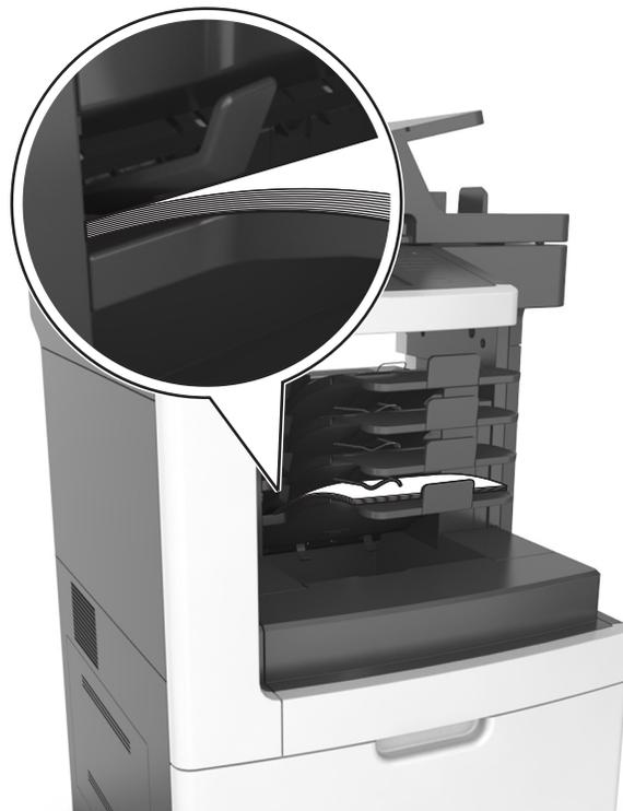
**Nota:** se la carta non si trova sotto il supporto, si verifica un inceppamento dovuto a un caricamento eccessivo del raccogliitore.
