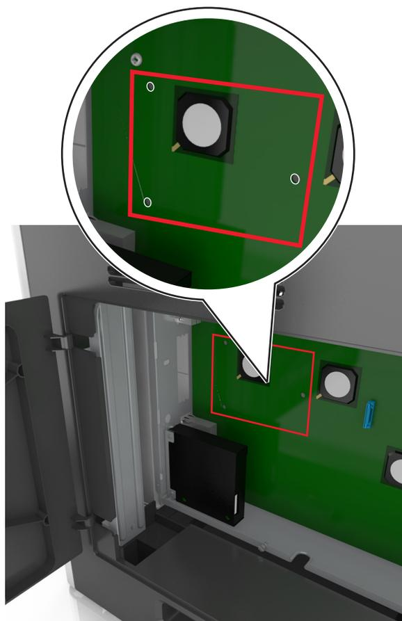
**Nota:** se attualmente è installato un ISP opzionale, è necessario installare il disco fisso della stampante sull'ISP.
