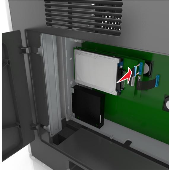
Per installare il disco fisso della stampante direttamente nell'alloggiamento della scheda del controller:
