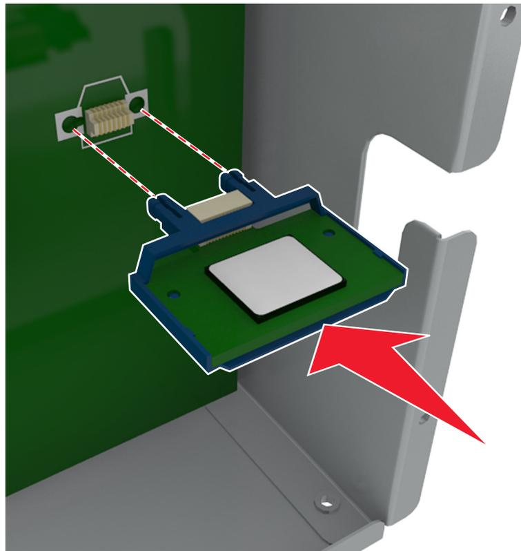
**Avvertenza — Danno potenziale:** L'installazione errata della scheda può danneggiare la scheda stessa e il controller.
