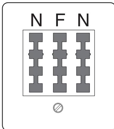
Conecte a impressora a qualquer uma das portas N.
