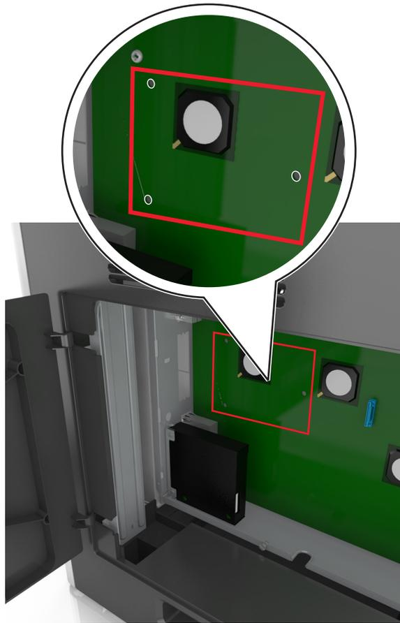
**Nota:** Se uma ISP opcional estiver atualmente instalada, o disco rígido da impressora deverá ser instalado na ISP.
