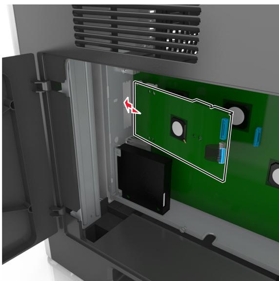
**Nota:** Ajuste a ISP no suporte de plástico, de forma que os conectores salientes passem pela abertura da ISP no compartimento.
