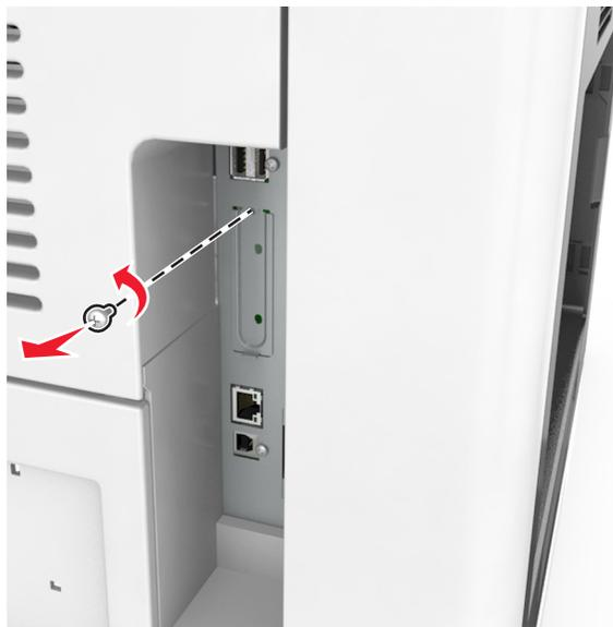
**b** Levante a tampa de metal e retire-a completamente.
