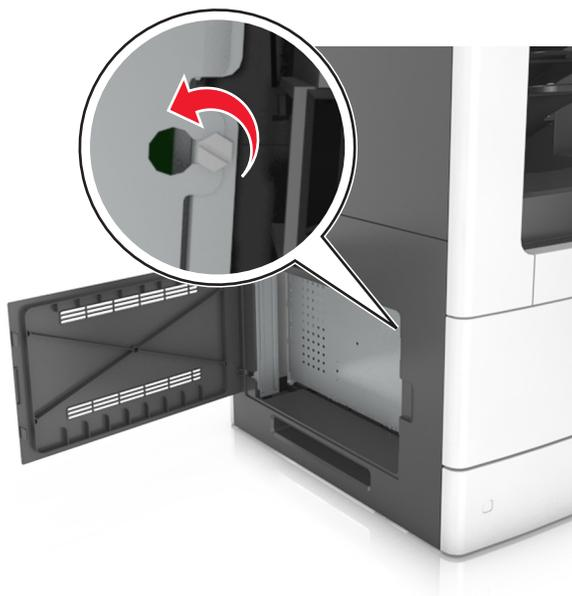
**3** Remova a proteção.
