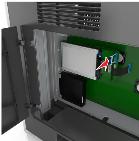
Para instalar o disco rígido da impressora diretamente na armação da placa do controlador:
