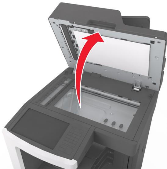
6 如果纸张卡在底部 ADF 盖门或 ADF 输出接纸架中，请打开底部 ADF 盖门，然后用力抓住被卡纸张的两边。
