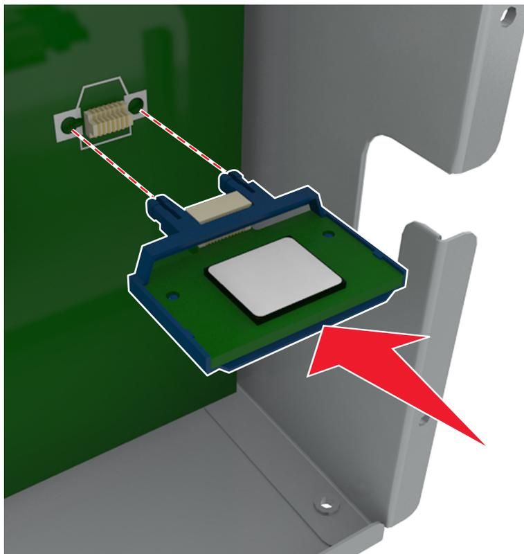
**警告—可能的损坏：**不正确安装卡可能造成卡和控制器板的损坏。
