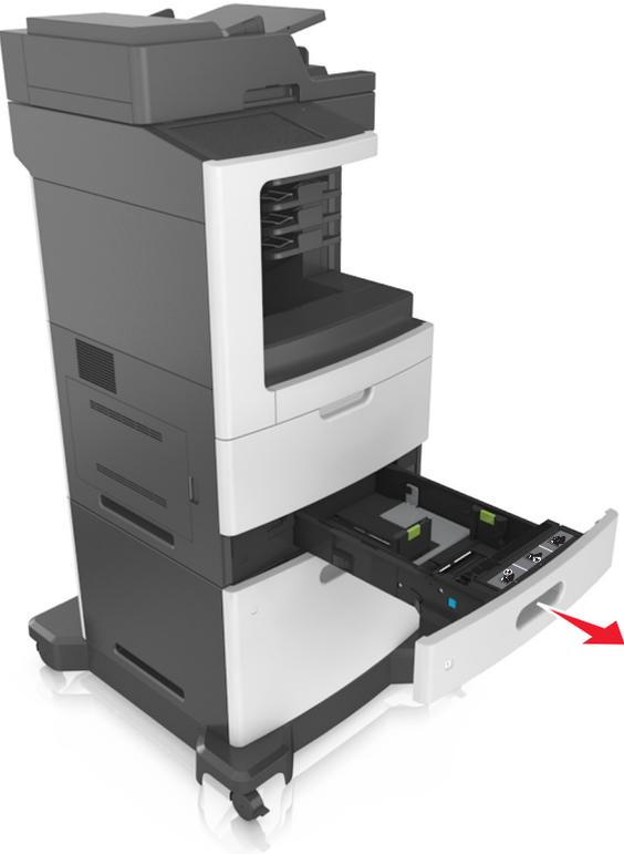
**2** 压住宽度导片，并将它滑动到与您加载的纸张尺寸相符的正确位置上，直到它发出“咔嚓”一声，卡入到位。
