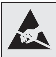
此符号表示对静电敏感的部件。请先接触打印机的金属外框，再接触这些符号附近的区域。
