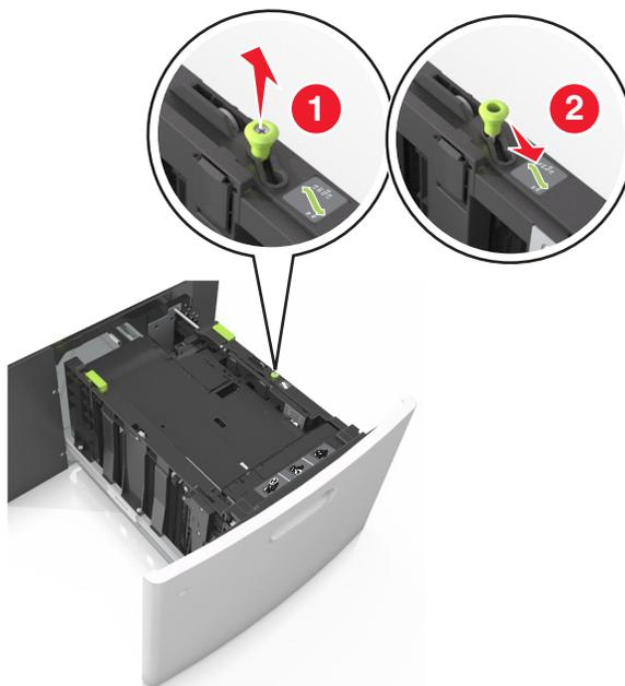
**b** 压住长度导片并将它滑动到 A5 的位置，直到它发出咔嚓一声，卡入到位。
