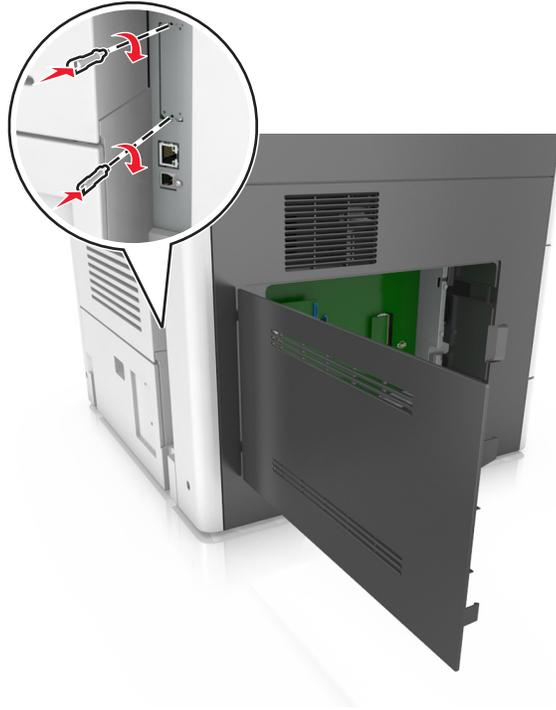
10 拧紧连接到 ISP 的翼形螺钉。
