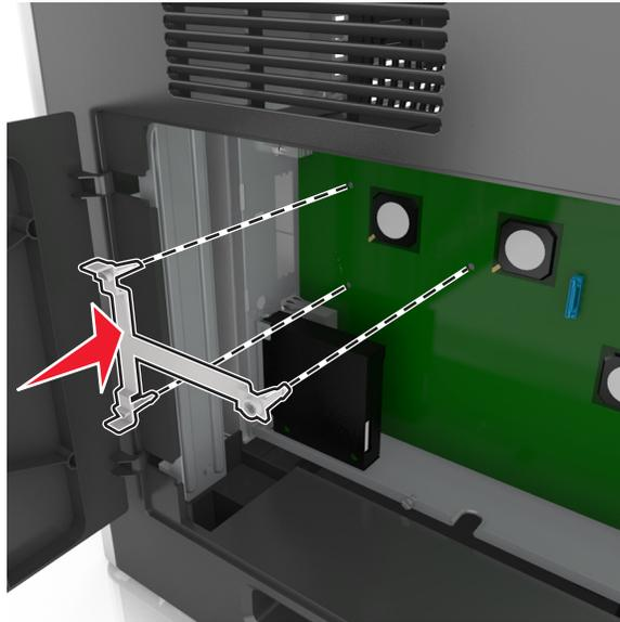
**注意：**确认塑料支架已经完全锁定，并且塑料支架被固定在框架上。
