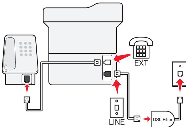
“数字用户线”将您的常规电话线路分为两个通道：语音和 Internet。电话和传真信号通过语音通道传输，而 Internet 信号通过另一个通道传输。这样，您可以使用同一条线路进行模拟语音呼叫（包括传真）和数字 Internet 访问。
