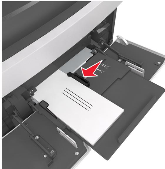
**警告—可能的损坏：**永远不要使用带有邮票、卡扣、摺扣、窗口、涂层或自动粘胶的信封。这些信封可能会严重损坏打印机。
