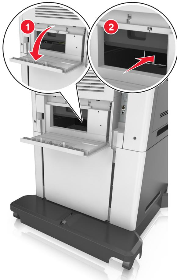
5 按下后部双面打印翻盖，接着用力抓住被卡的纸张，然后轻轻地拉出纸张。
