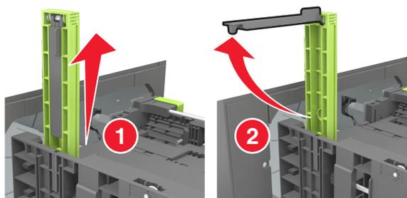
d 将 A5 长度导片插入其指定的插槽中。
