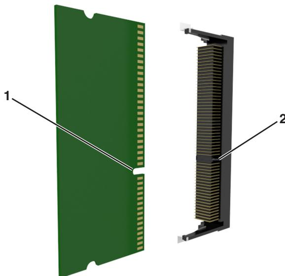
4 将内存卡笔直推入连接器中，然后将卡朝着控制器板墙推，直到它发出咔嚓一声，卡入到位。
