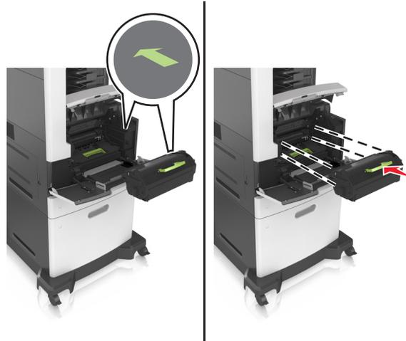
**警告—可能的损坏：**当更换碳粉盒时，不要让成像部件长时间暴露在直接的光线下。长时间暴露在光线下可能导致打印质量问题。
