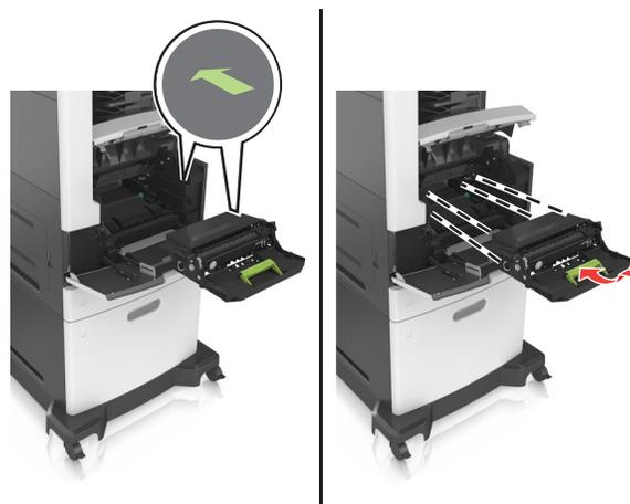
7 将碳粉盒的侧导轨与打印机内部侧导轨上的箭头对齐，然后将碳粉盒插入打印机中。
