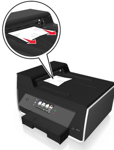
**Hinweis:** Stellen Sie sicher, dass alle Papierteile entfernt werden.
