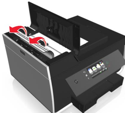
**Hinweis:** Stellen Sie sicher, dass alle Papierteile entfernt werden.
