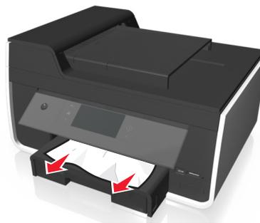
**Hinweis:** Stellen Sie sicher, dass alle Papierteile entfernt werden.
