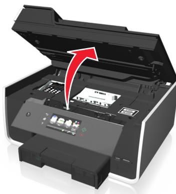
**Hinweis:** Der Druckkopf wird in die Position zum Einsetzen der Patronen gefahren.
