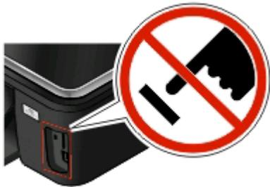
**경고—손상 위험:** 메모리 장치에서 인쇄, 읽기 또는 쓰기 작업 중으로 표시되는 영역의 케이블이나 네트워크 어댑터, 커넥터, 메모리 장치 또는 프린터를 만지지 마십시오. 데이터 손실이 발생할 수 있습니다.
