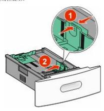
2 解锁长度导片,向内压住长度导片凸柱,并将它滑动到与 加载的纸张尺寸相符的正确位置上。
