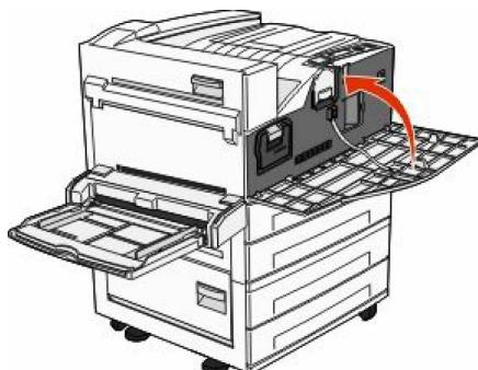
**Napomena:** Nakon umetanja fotovodiča i zatvaranja svih vratašaca, pisač obavlja ciklus pokretanja motora i briše sva upozorenja o zamjeni fotovodiča.
