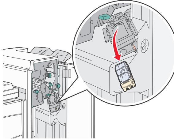
4 Heben Sie den Heftklammerschutz mit Hilfe der Metallasche hoch, und ziehen Sie anschließend den Heftklammerbogen heraus.
