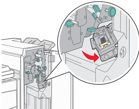
3 Ziehen Sie kräftig an der farbigen Lasche, um die Heftklammerkassette zu entfernen.
