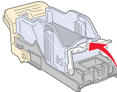
5 Sie können über die durchsichtige Abdeckung an der Unterseite der Heftklammerkassette überprüfen, ob alle gestauten Heftklammern in der Eingangsöffnung entfernt wurden.
