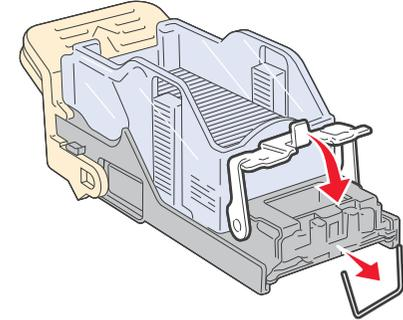
7 Drücken Sie die Heftklammerkassette fest in den Hefter, bis die Heftklammerkassette einrastet.
