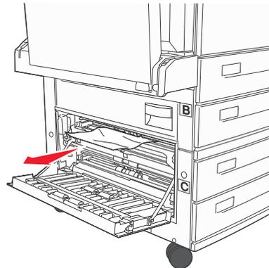
**Hinweis:** Stellen Sie sicher, dass alle Papierteile entfernt werden.
