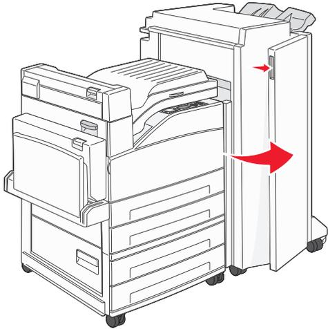
2 Halten Sie den Hebel an der Heftklammerkassette und bewegen Sie sie nach rechts.
