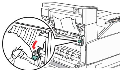
**Hinweis:** Wenn sich das Papier nicht gleich herausziehen lässt, sollten Sie nicht weiterziehen. Drücken Sie den grünen Hebel nach unten und ziehen Sie am Hebel, damit sich das Papier leichter entfernen lässt. Stellen Sie sicher, dass alle Papierteile entfernt werden.
