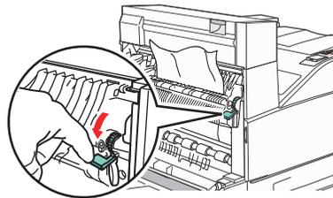
**Hinweis:** Wenn sich das Papier nicht gleich herausziehen lässt, sollten Sie nicht weiterziehen. Drücken Sie den grünen Hebel nach unten und ziehen Sie am Hebel, damit sich das Papier leichter entfernen lässt. Stellen Sie sicher, dass alle Papierteile entfernt werden.
