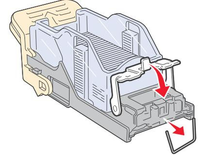
7 Empuje con firmeza el soporte del cartucho para introducirlo en la grapadora hasta que encaje en su lugar.
