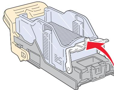
5 Mire en el hueco que hay en la parte inferior del soporte del cartucho para asegurarse de que no quedan grapas atascadas en el orificio de entrada.
