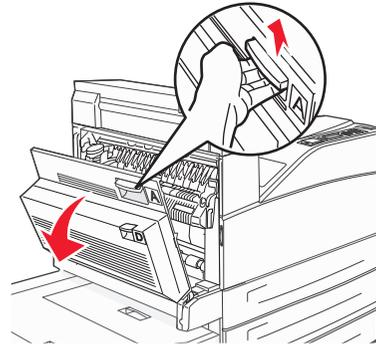
**MISE EN GARDE—SURFACE BRULANTE:** l'intérieur de l'imprimante risque d'être brûlant. Pour réduire le risque de brûlure, laissez la surface du composant refroidir avant d'y toucher.
