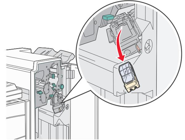
4 С помощью металлического язычка поднимите защитную крышку сшивателя, затем извлеките пластину скоб.
