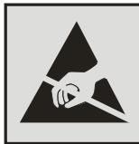
Ovaj simbol označava dijelove osjetljive na statički elektricitet. Nemojte dirati područja označena ovim simbolom a da prije toga ne dodirnete metalni okvir pisača.
