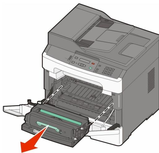
**2** Heben Sie die Klappe vorne am Drucker an und beseitigen Sie sämtliches gestautes Papier.
