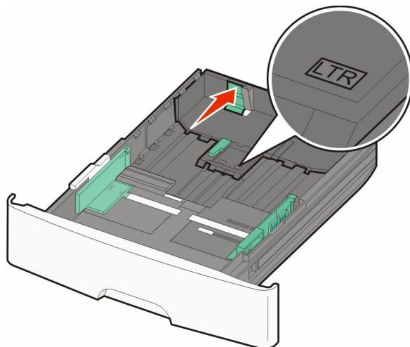
Si está cargando un tamaño de papel mayor, presione la lengüeta de la guía de longitud y deslícela hacia la posición adecuada para conseguir el tamaño determinado. La bandeja se extiende hacia atrás como se muestra.
