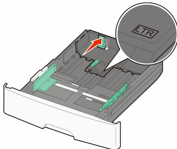
Para carregar um papel maior, aperte as abas da guia de comprimento e deslize a guia de comprimento para trás até a posição correta para o tamanho do papel. A bandeja desliza de volta conforme ilustrado.
