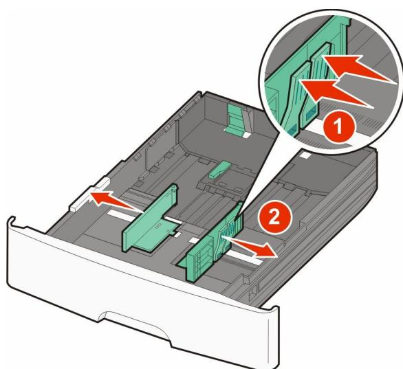
**3** Aperte as abas da guia de comprimento ao mesmo tempo, conforme ilustrado, e deslize a guia de comprimento para a posição correta, de acordo com o tamanho do papel. Use os indicadores de tamanho da parte inferior da bandeja para ajudar a posicionar a guia.
