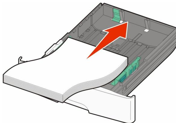
Carregue papel timbrado com o lado impresso voltado para baixo e a borda superior da folha para a parte frontal da bandeja.
