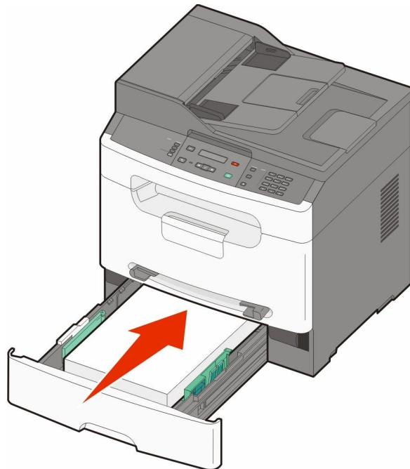
**8** Если в лоток была загружена бумага, тип которой отличается от того, что был загружен ранее в лоток, измените параметр типа бумаги для лотка.
