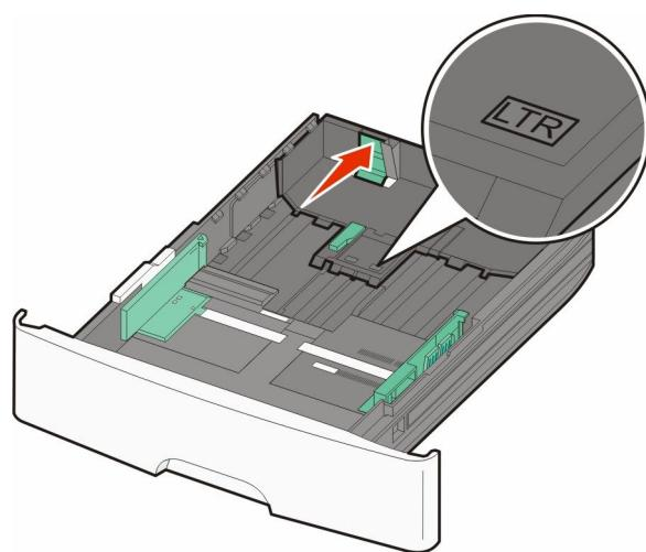
Если выполняется загрузка более длинной бумаги, нажмите на фиксатор направляющей длины бумаги и сдвиньте направляющую длины бумаги назад в положение, соответствующее формату загружаемой бумаги. Лоток выдвигается назад, как показано на рисунке.
