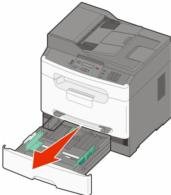
**2** 如图所示，压住右纸张导片上的宽度导片凸柱，然后将宽度导片滑动到进纸匣的两边。宽度导片同时移动。
