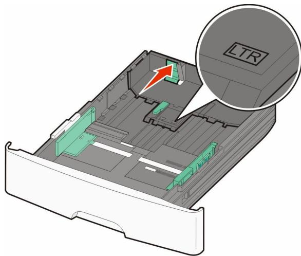
如果您加载较长尺寸的纸张，请压住长度导片凸柱，然后将长度导片向后滑动到与加载的纸张尺寸相符的正确位置上。进纸匣向后延伸，如图所示。
