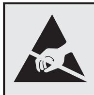
Mit diesem Symbol sind Teile gekennzeichnet, die gegen statische Aufladungen empfindlich sind. Berühren Sie die Bereiche um diese Symbole erst, nachdem Sie den Metallrahmen des Druckers angefasst haben.
