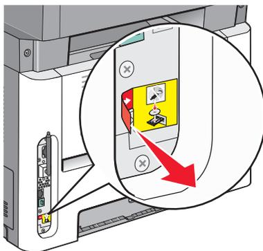
**8** Temporariamente conecte o cabo USB entre o computador conectado a rede de conexão wireless e a impressora.
