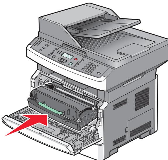
**8** Após substituir o kit fotocondutor, reinicie o contador do fotocondutor. Para redefinir o contador do fotocondutor, consulte a folha de instruções fornecida com o novo kit fotocondutor.
