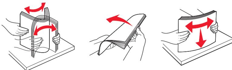
**4** Carregue a pilha de folhas em direção a parte traseira da bandeja, conforme a figura, com o lado para a impressão voltado para baixo.
