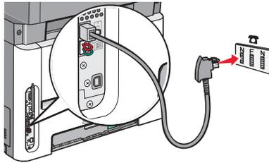
**4** Se desejar usar a mesma linha para a comunicação por fax e telefone, conecte uma segunda linha de telefone (não fornecida) entre o telefone e o slot F de uma tomada de telefone analógica ativa.
