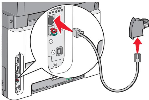
**3** Conecte o adaptador no slot N de uma tomada de telefone analógico ativa.
