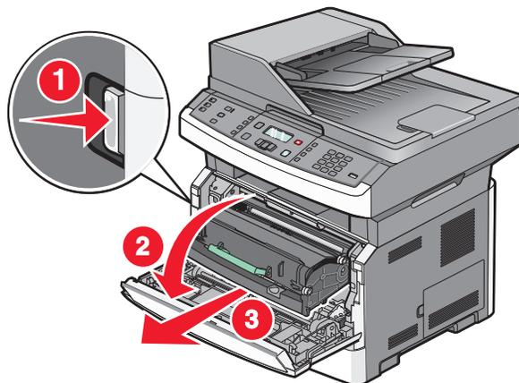
2 Levante a aba da parte frontal da impressora e remova as folhas atoladas.
