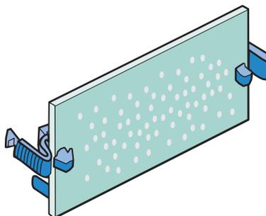
**Nota:** Evite tocar nos pontos de conexão ao longo da borda da placa.
