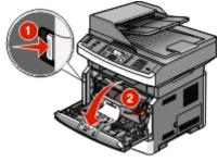
Drücken Sie auf die Entriegelung und öffnen Sie die vordere Klappe.
