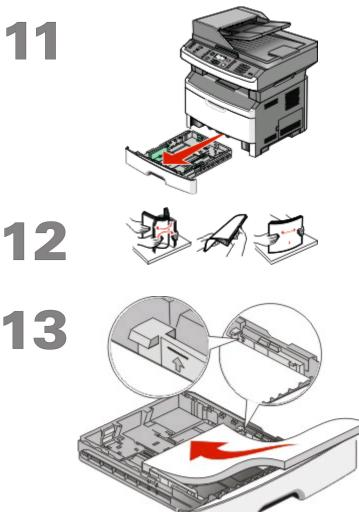
Biegen Sie den Stapel in beide Richtungen, um die Blätter voneinander zu lösen, und fächern Sie den Stapel auf. Das Papier darf nicht geknickt oder geknittert werden. Gleichen Sie die Kanten auf einer ebenen Fläche an.
