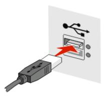
2 Schließen Sie den kleinen, viereckigen Steckverbinder an den Drucker an.
