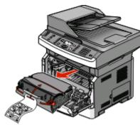
Entfernen Sie das Fotoleiter-Kit und die Druckkassette aus dem Drucker.
