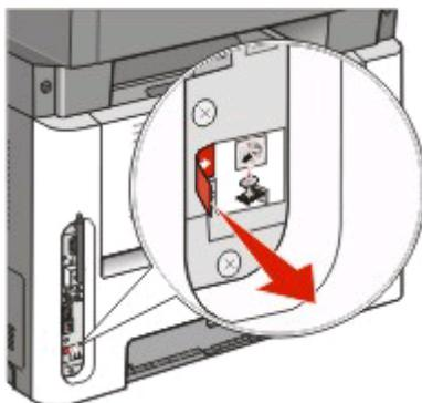
7 Подсоедините кабель USB к порту USB на компьютере и порту USB на задней панели принтера.
