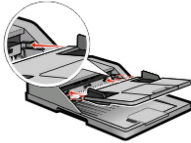
Установите лоток устройства автоматической подачи.
