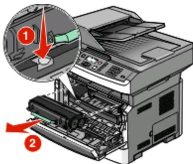
Нажмите кнопку на основании комплекта фотобарабана. Вытяните картридж с тонером за ручку вверх.
