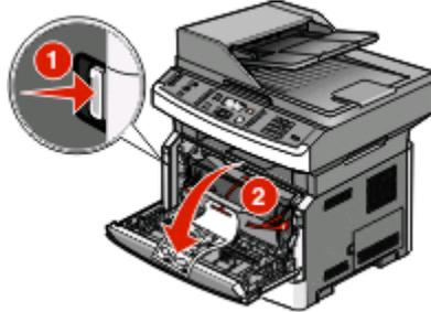
Нажмите кнопку фиксатора и опустите переднюю дверцу.
