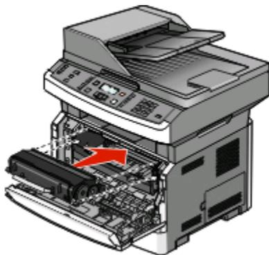
将碳粉盒上的辊与导轨对齐，将碳粉盒插入感光鼓组件中。推入碳粉盒，直到它发出**咔嚓**一声安装到位。
