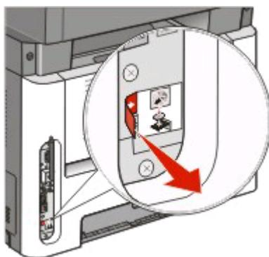
7 将 USB 电缆连接到计算机上的 USB 端口和打印机后部的 USB 端口。
