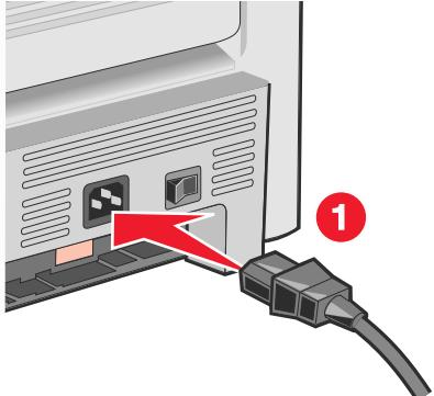
Sluit het netsnoer aan op de printer en vervolgens op een geaard stopcontact dat zich dicht in de buurt van de printer bevindt en dat eenvoudig bereikbaar is. Zet de printer aan.
