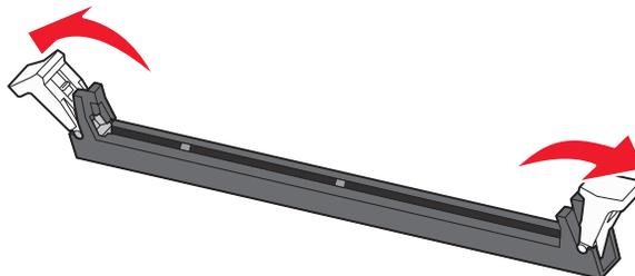
4 Richten Sie die Aussparungen an der Speicherkarte an den Vorsprüngen auf dem Steckplatz aus.
