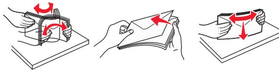
**Hinweis:** Durch das Auffächern wird verhindert, dass die Kanten der Briefumschläge zusammenkleben. Dadurch werden sie ordnungsgemäß eingezogen. Die Briefumschläge dürfen nicht geknickt oder geknittert werden.
