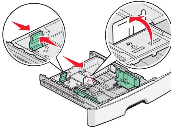
**Nota:** utilizzare gli indicatori delle dimensioni sul fondo del vassoio per posizionare la guida.
