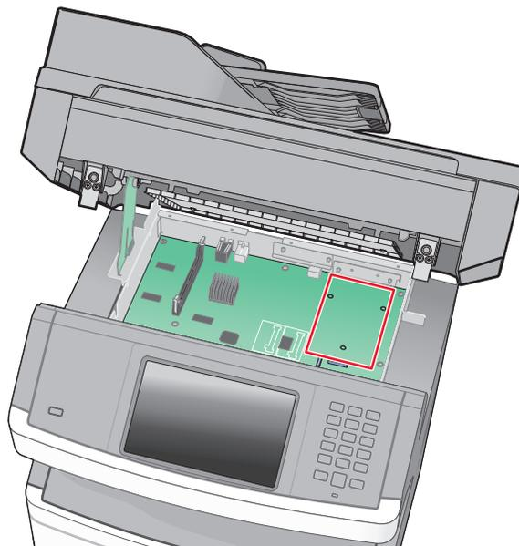
**Nota:** se è attualmente installato un disco fisso della stampante opzionale, è prima necessario rimuovere il disco fisso della stampante. Per rimuovere il disco fisso:
