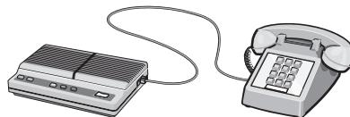
**5** Conecte un tercer cable telefónico del contestador automático al puerto EXT
