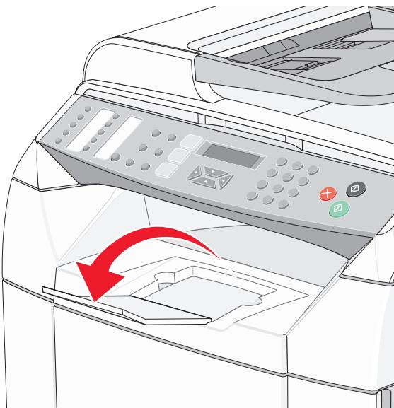
Опора для бумаги наклонена, поэтому из складываемой бумаги в выходном лотке формируется аккуратная стопка.
