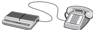
**5** Соедините третьим телефонным кабелем автоответчик и порт EXT
