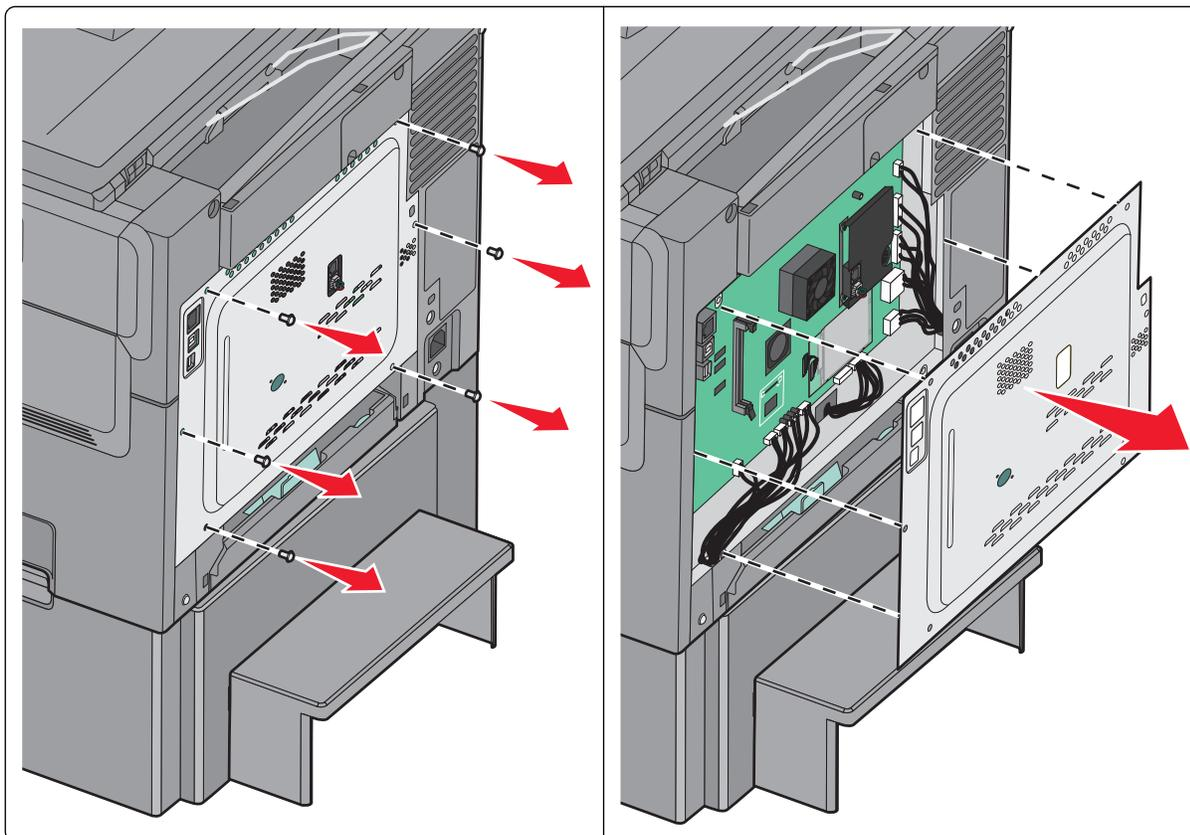
**Avvertenza — Danno potenziale:** i componenti elettrici della scheda di sistema sono facilmente danneggiati dall'elettricità statica. Prima di toccare un componente o connettore elettronico della scheda di sistema, toccare un oggetto metallico.
