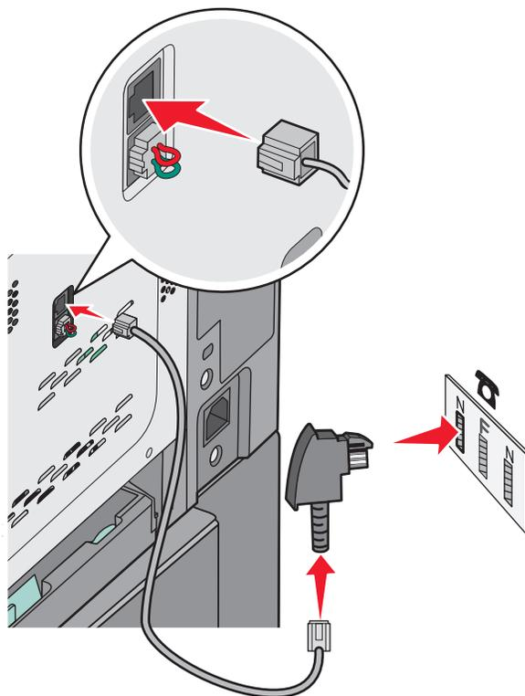
**3** Collegare l'adattatore nello slot N di una presa a muro telefonica analogica attiva.
