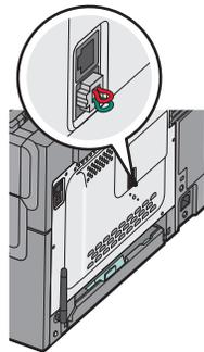
**Remarque :** ne retirez pas cette prise si vous disposez d'un système téléphonique en série ou si vous souhaitez brancher un téléphone ou un répondeur sur l'adaptateur. Si vous le faites, les autres appareils de télécommunication installés chez vous (par exemple, des téléphones ou des répondeurs) risquent de ne plus fonctionner.
