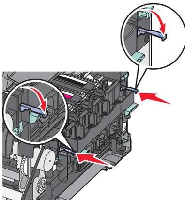
**16** Faites pivoter les leviers de couleur bleue jusqu'à ce que le kit de traitement d'images soit correctement mis en place.
