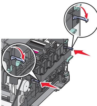
**14** Sostituire il contenitore del toner di scarto.
