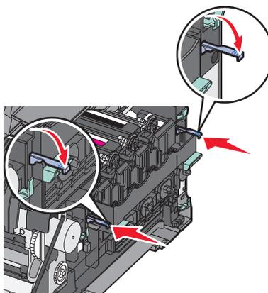
**15** Sostituire il contenitore del toner di scarto.
