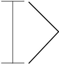
Por ejemplo, la distancia entre estas dos marcas representa un defecto repetitivo que se produce cada 34,6 mm (1,4 pulg.), lo que significa que puede que sea necesario sustituir la unidad del fotoconductor.
