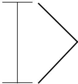
Ad esempio, la distanza tra questi due segni rappresenta un difetto ricorrente che si verifica ogni 34,6 mm (1,4 pollici) e indica che è necessario sostituire l'unità fotoconduttore.
