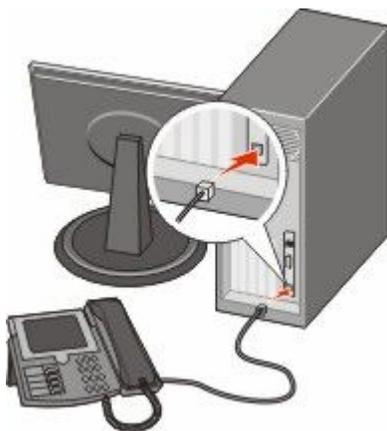
5 Verbinden Sie das dritte Telefonkabel zuerst mit dem Computermodem und dann mit dem unteren EXT-Anschluss
