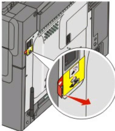
7 Schließen Sie das Installationskabel an einen USB-Anschluss am Computer und an den USB-Anschluss des Druckers an.
