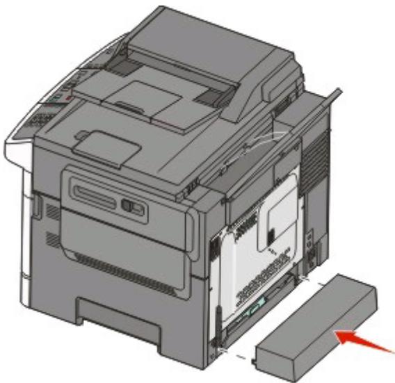
Bringen Sie die Schutzabdeckung wie dargestellt an der Rückseite des Druckers an.
