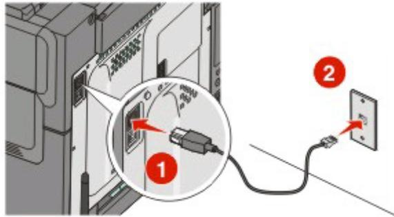
Stellen Sie sicher, dass der Computer, den Sie zur Druckerkonfiguration nutzen, an einen funktionierenden Netzwerkanschluss im selben Netzwerk wie der Drucker angeschlossen ist.
