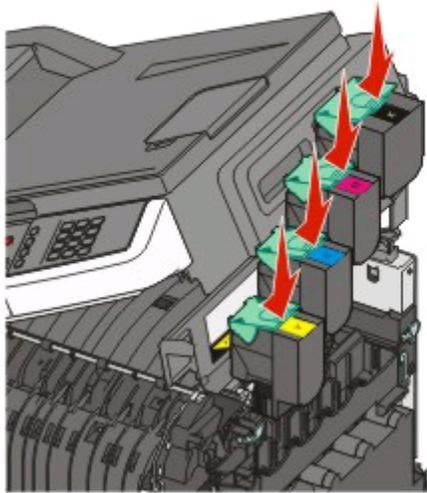
Richten Sie die Druckkassetten aus, und setzen Sie sie wieder in den Drucker ein.
