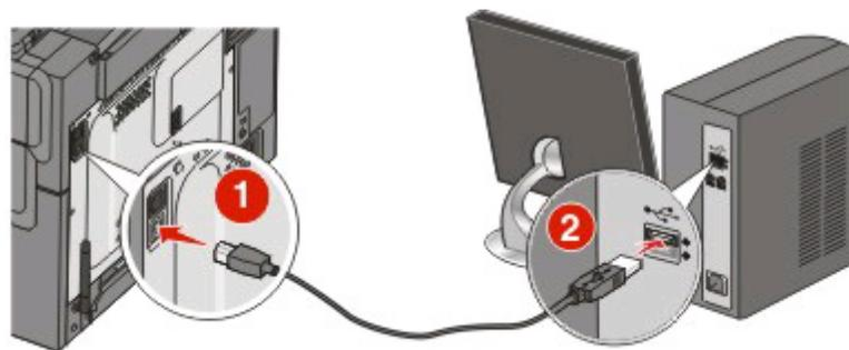
Anschluss über ein USB-Kabel
