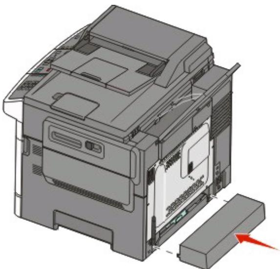
Instale la cubierta antipolvo de la bandeja de papel en la parte posterior de la impresora como se indica.
