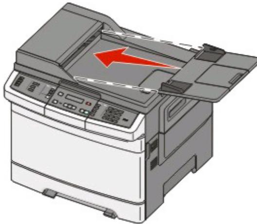
Instale la bandeja ADF, la bandeja de salida y el porta-papeles en la impresora como se indica.
