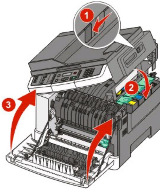
Deslice el pestillo de liberación a la izquierda y presione hacia abajo para cerrar la cubierta superior y, a continuación, cierre la puerta frontal.
