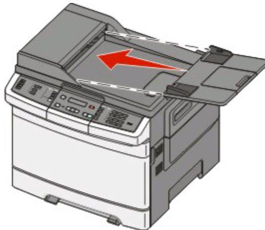
Прикрепите лоток устройства автоматической подачи, выходной лоток и скобу для бумаги к принтеру, как показано на рисунке.
