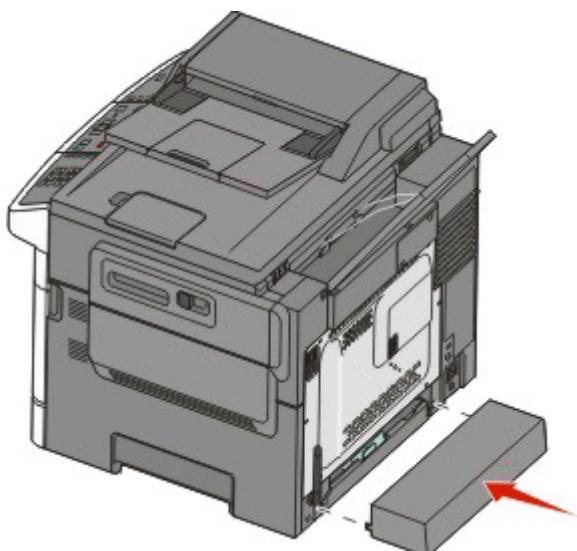
Присоедините пылезащитную крышку лотка подачи бумаги к задней части принтера, как показано на рисунке.
