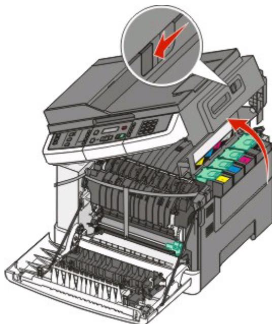
Сдвиньте фиксатор влево и откройте верхнюю крышку.
