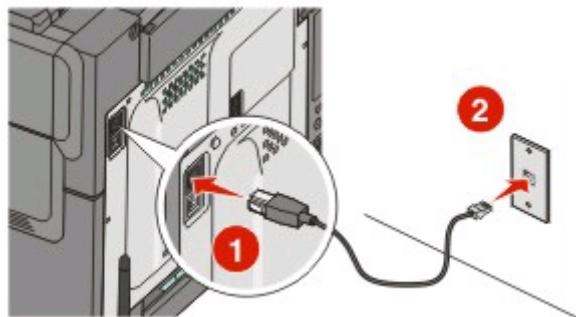
Убедитесь в том, что компьютер, который используется для настройки принтера, подключен к исправному сетевому порту, который находится в той же сети, что и принтер.
