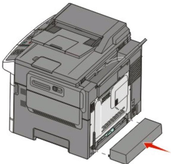
将进纸匣防尘盖板安装在打印机的后部，如图所示。
