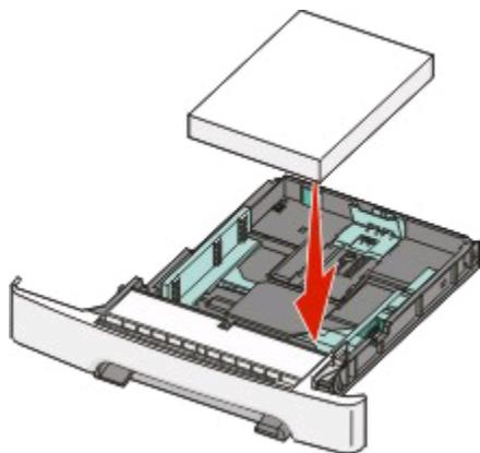
将纸张加载到进纸匣中，如图所示。
