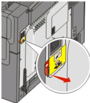
7 将安装电缆连接到计算机上的 USB 端口和打印机后部的 USB 端口。
