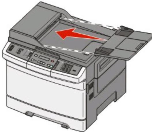
将 ADF 进纸匣、输出托盘和纸张卡紧箍安装到打印机上，如图所示。
