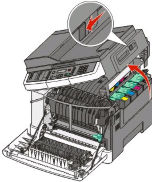
将释放插销向左滑动并上抬来打开顶部盖板。
