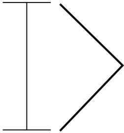
例如，这两个标记之间的距离表示缺陷每隔 34.6 毫米（1.4 英寸）重复出现，说明感光鼓部件可能需要更换。
