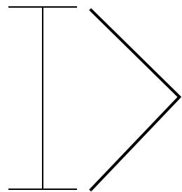
例如：這兩個記號之間的距離，代表每隔 34.6 公釐（1.4 英吋）重複出現的瑕疵，表示您可能需要更換感光鼓組件。
