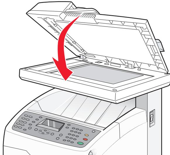
**7** بعد إزالة كل الورق المحشور، تظهر الرسالة **Return the Removed Original and Press Start** (أعد الجزء الأصلي المزال واضغط على "بدء"). ضع المستند الأصلي في وحدة تعذية المستندات الأصلية، ثم اضغط على **Start** (بدء) للاستمرار في مهمة المسح الصوتي.
