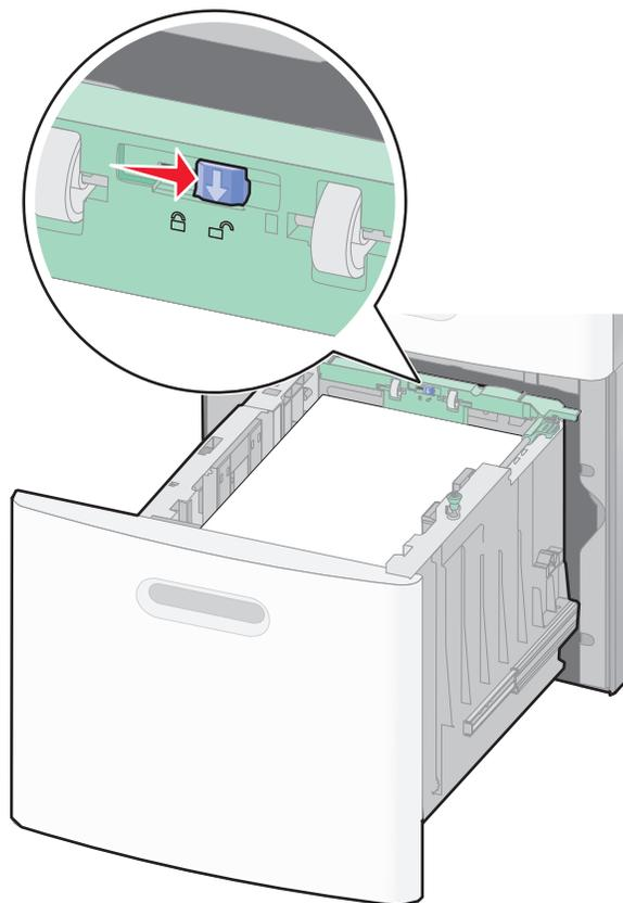
**4** Empuje el pestillo de liberación de la guía de longitud para levantarla, deslice la guía hasta la posición que se corresponda con el tamaño del papel cargado y, a continuación, bloquee la guía.
