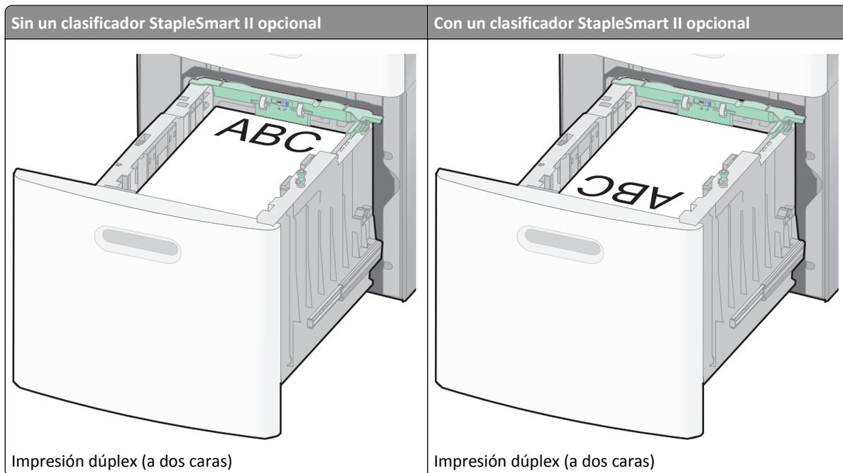
**Nota:** Observe la línea de carga máxima en el lado de la bandeja que indica la altura máxima de carga del papel. No sobrecargue la bandeja.
