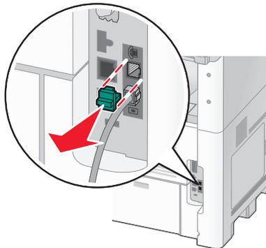
**4** Conecte el otro cable telefónico a un teléfono y, a continuación, enchúfelo al puerto EXT
