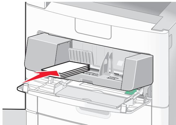
**Nota:** No exceda la altura de pila máxima intentando introducir más papel bajo el limitador de altura de pila.
