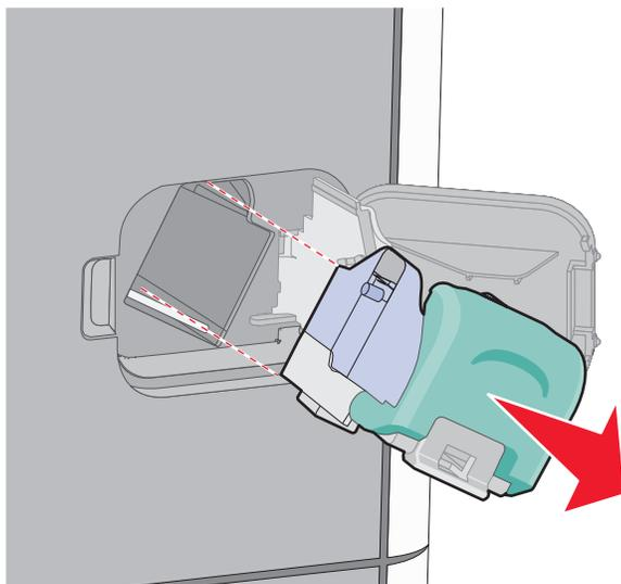
4 Utilice la lengüeta metálica para levantar la protección de grapas y extraiga las grapas sueltas.
