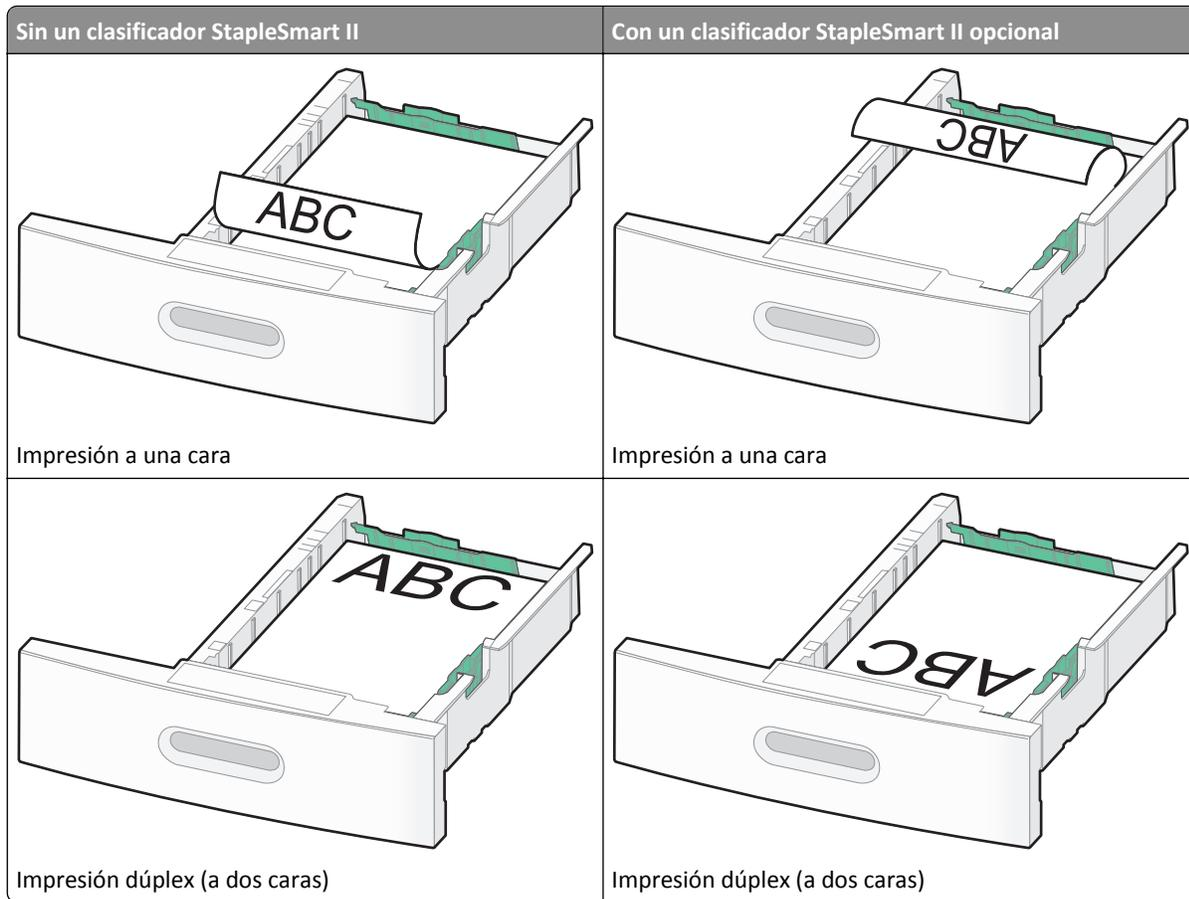
**Nota:** Observe la línea de carga máxima en el lado de la bandeja que indica la altura máxima de carga del papel. No sobrecargue la bandeja.
