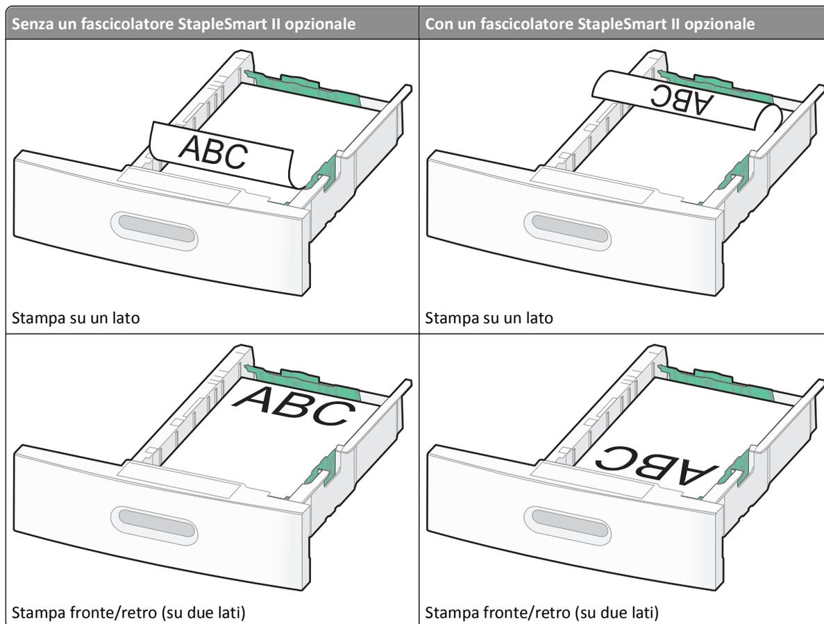
**Nota:** tenere presente il limite massimo di caricamento presente sul lato del vassoio che indica l'altezza massima per il caricamento della carta. Non caricare eccessivamente il vassoio.
