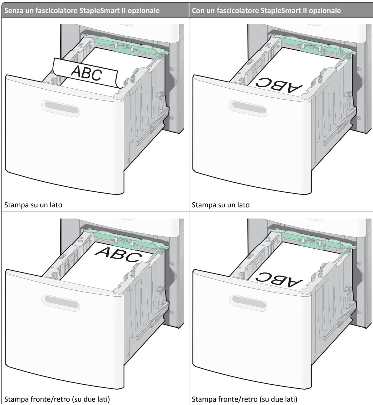
**Nota:** tenere presente il limite massimo di caricamento presente sul lato del vassoio che indica l'altezza massima per il caricamento della carta. Non caricare eccessivamente il vassoio.
