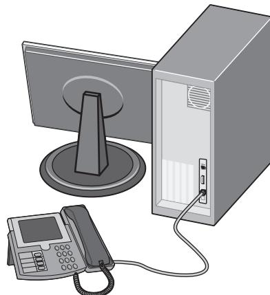
**5** 将第三条电话线从计算机调制解调器连接到打印机的 EXT 端口
