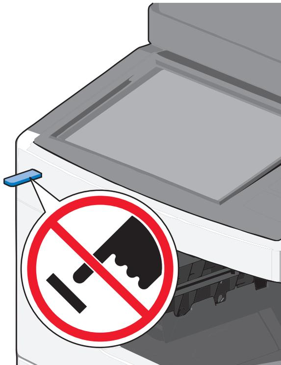
**Warnung - Mögliche Schäden:** USB-Kabel, Netzwerkadapter, Anschlüsse, Speichermedium oder Drucker sollten im angezeigten Bereich während eines Druck-, Lese- oder Schreibvorgangs mittels Speichermedium nicht berührt werden. Es kann ein Datenverlust auftreten.
