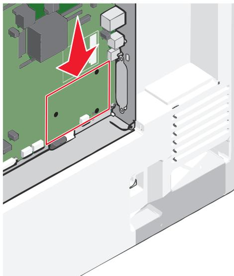
**Nota:** se attualmente è installato un ISP opzionale, è necessario installare il disco fisso della stampante sull'ISP.
