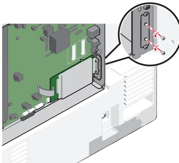
**b** Rimuovere le viti che fissano la staffa di montaggio del disco fisso della stampante al disco stesso, quindi rimuovere la staffa.
