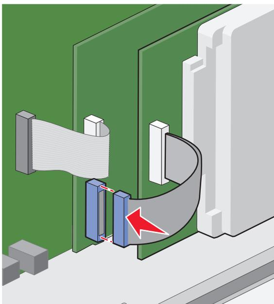
Per installare il disco fisso di una stampante direttamente nella scheda di sistema:
