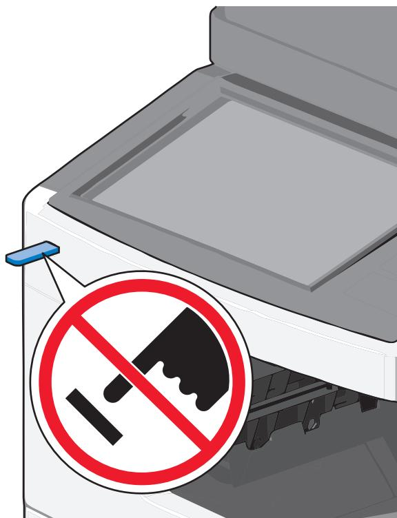
**警告—可能的损坏：**当正在从内存设备打印、读取或写入时，请勿触摸所示区域中的 **USB** 电缆、任何网络适配器、任何连接器、内存设备或打印机。可能会丢失数据。
