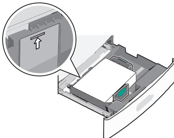
**6** Inserire il vassoio.
