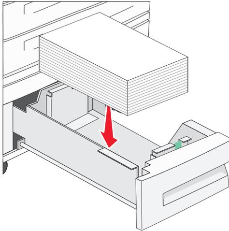
注意：确认打印介质在后部导片上的最大加载线下方。过量加载可能会引起卡纸。
