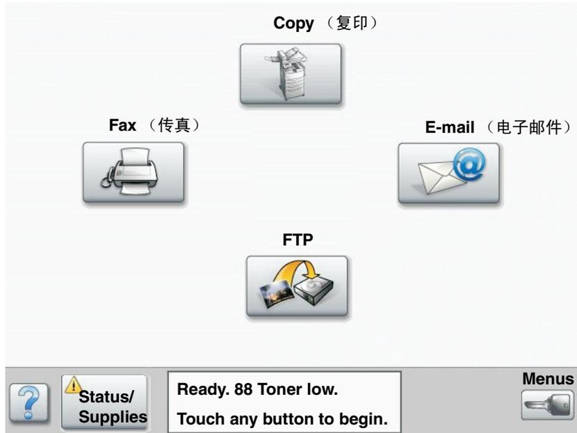
一旦需要消耗品部件或维护，MFP 控制板上会发出警报提醒您。触摸屏底部的打印状态消息栏指出 MFP 是否处于 **Ready**（就绪）状态，并让您知道是否有消耗品不足或已空。触摸屏幕底部的 **Status / Supplies**（状态 / 消耗品），将打开 **Status / Supplies**（状态 / 消耗品）屏幕，您可以在这里查看各个进纸匣和其它消耗品部件的状态。
