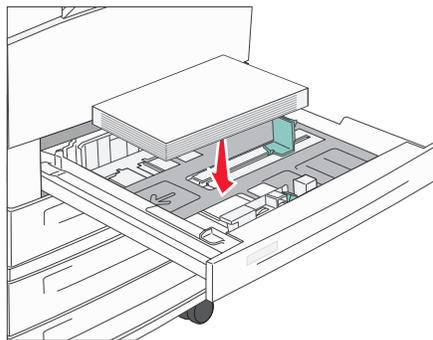
要使 MFP 能识别按短边进纸方向加载的美国信纸或 A4 尺寸的打印介质，“短边打印”必须被启用。
